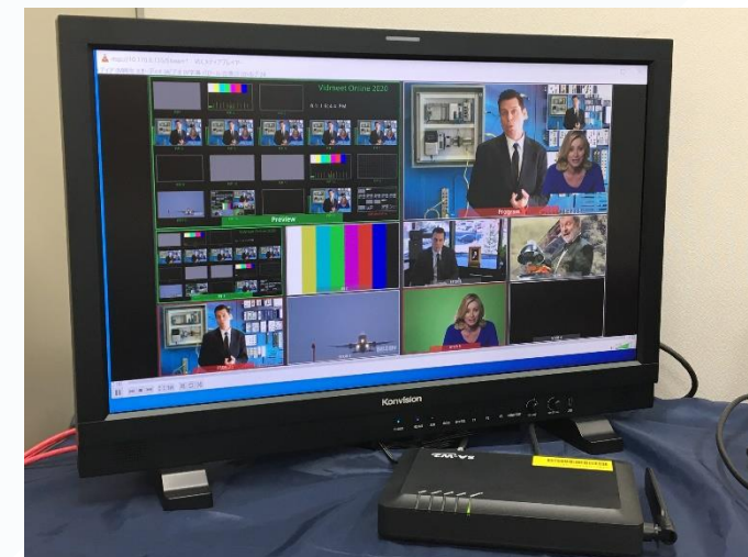
データセンターからのマルチビューアウト用モニターとVPN装置
