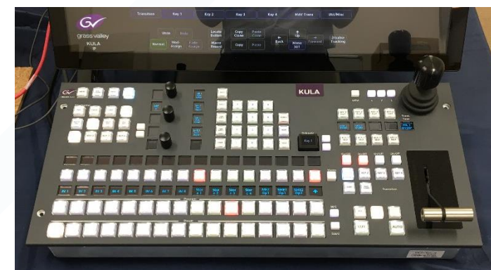
19インチラックマウントサイズのKula スイッチャーコントロールサーフェース
